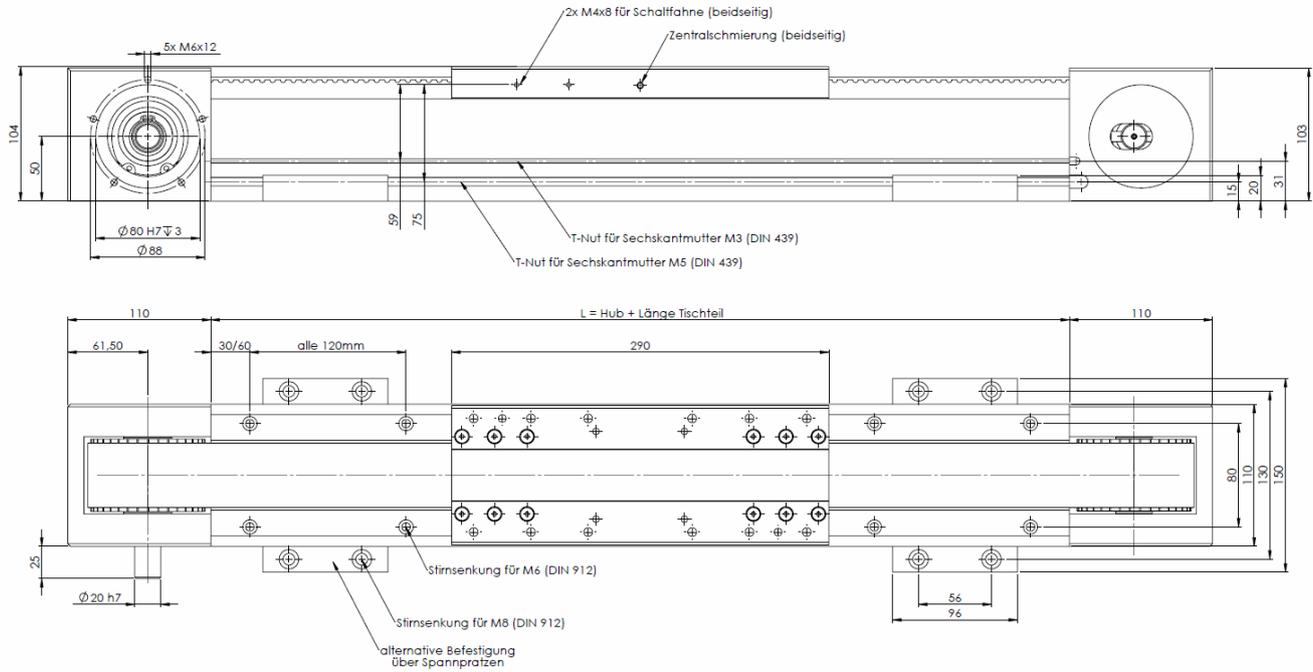
Abbildung 3: Anschlussmaße, Linearachse
