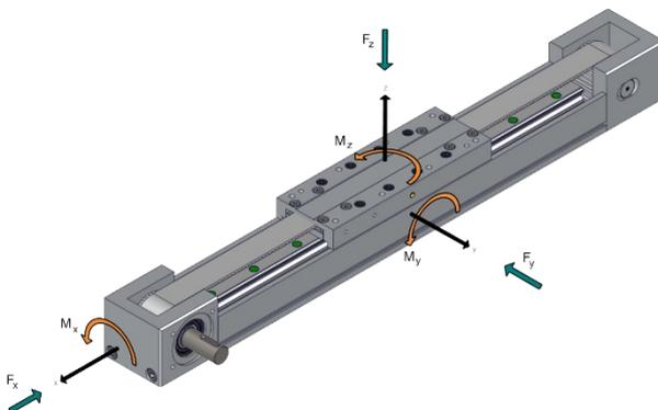
Abbildung 2: mechanische Belastungen
